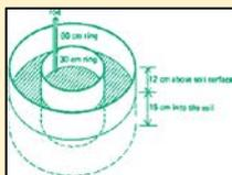
El equipo de SUN utilizó un infiltrómetro de doble anillo para medir la tasa de infiltración en las áreas del proyecto. El infiltrómetro consta de dos anillos metálicos concéntricos que se introducen en el suelo, una placa motriz, un martillo de absorción de impactos, puentes de medición y barras de medición con flotadores.
